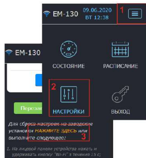
Рисунок 13 – Сброс настроек с Web-интерфейса
